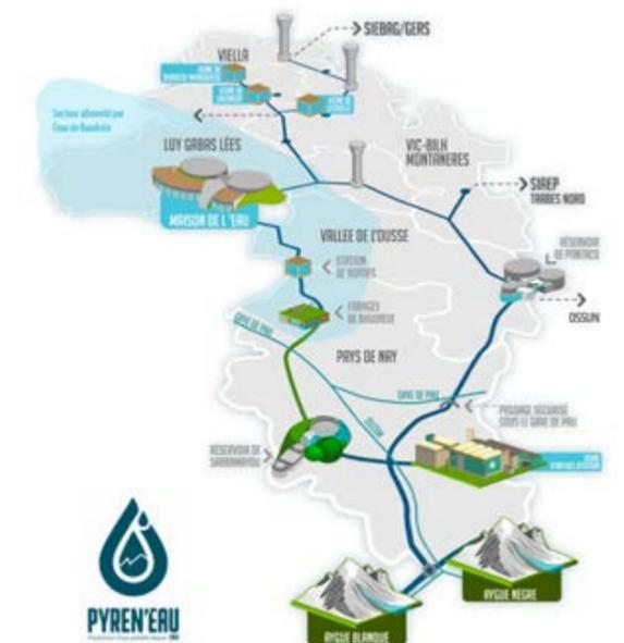
L'eau pompée dans la nappe du gave, transite par l'usine d'eau potable de Bordes; elle est alors contrôlée et traitée (chloration) avant d'être stockée aux réservoirs de la Maison de l'eau à Buros. Le syndicat de distribution Luys Gabas Léés prend ensuite le relais pour la distribution à chaque abonné.
